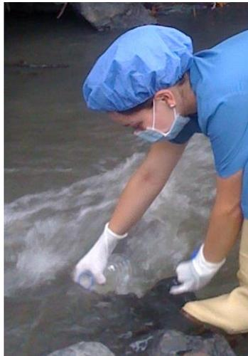
2. Toma de muestras en ríos y quebradas: el frasco se coloca boca abajo, se destapa cerca de la superficie del agua cuidando de no poner la tapa en contacto con el suelo, se introduce el frasco tomado por la base hasta una profundidad de 15cm., dentro del agua, luego se voltea y se mueve contra la corriente hasta llenar 500ml.
